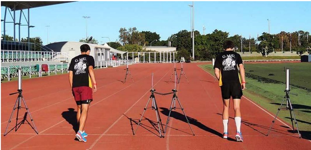
ภาพที่ 2.12 การจับเวลาความเร็วในการวิ่งโดยใช้เครื่อง Sports Timing for Speed (ที่มาของภาพ : https://simplifaster.com/articles/buyers-guide-sports-timing/ )
